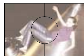
Nach der Analyse der Messblitze ignoriert die TTL-Blitzsteuerung in dieser Szene das linke obere Messfeld.
